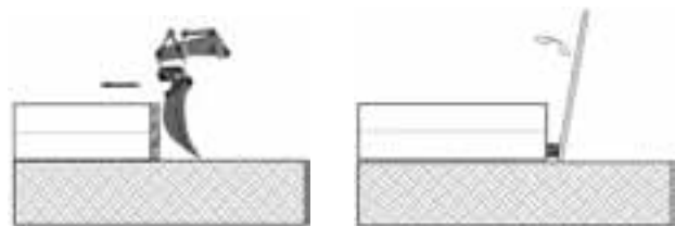
Abbildung 4-1-7 Montage mit Baggerschaufel oder mit Brechstange
